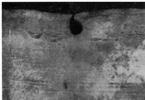
Abb. 17. Stück aus der Bleimantelhülle eines Telefonkabels. Durch Dermestes vulpinus -Larven beschädigt
